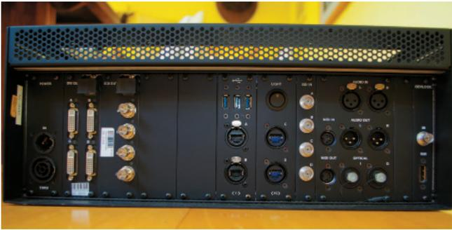
**Rückseite 2x4** von links nach rechts: Netzeingang und -weiterleitung, 2 × VFC-Ausgangskarten (hier DVI und SDI), USB- und Netzwerkanschlüsse, Lichtschalter für eingebaute Rückseitenbeleuchtung, SDI-Eingänge, MIDI-Ein- und Ausgang, Audio-Ein- und Ausgänge (XLR und optisch), Anschluss für Genlock und GUI
